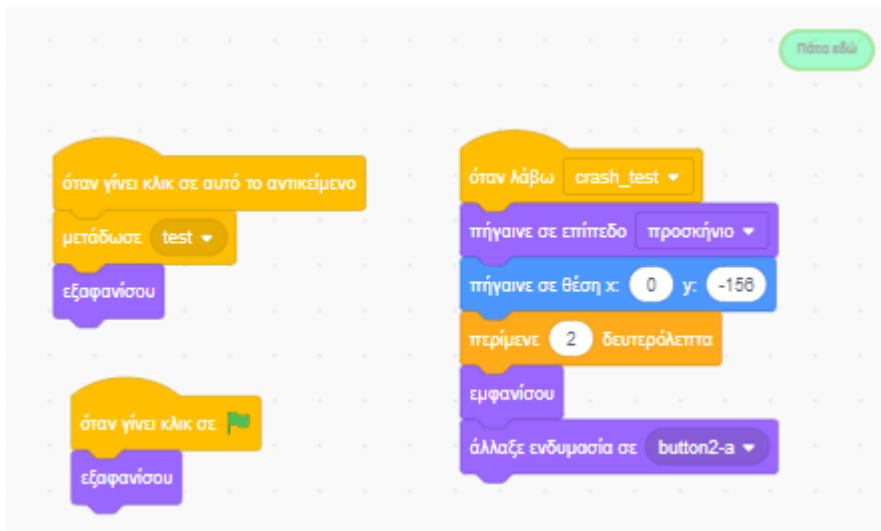
Εικόνα 90. Κώδικας πλήκτρου εκκίνησης των δοκιμών με τον τοίχο για τη σωστή τοποθέτηση του αισθητήρα στο φυσικό μοντέλο (βαθμονόμηση αισθητήρα)
